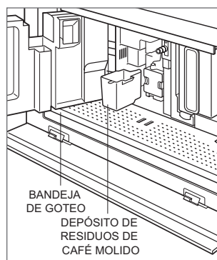
Bandeja recolectora y recipiente de residuos de café molido
